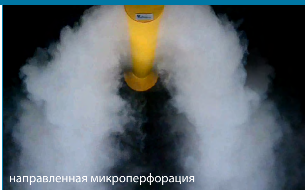
Примеры воздушных потоков, созданные с помощью дымовых экспериментов в лаборатории PRIHODA
