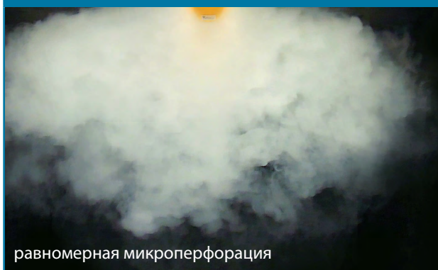
Примеры воздушных потоков, созданные с помощью дымовых экспериментов в лаборатории PRIHODA
